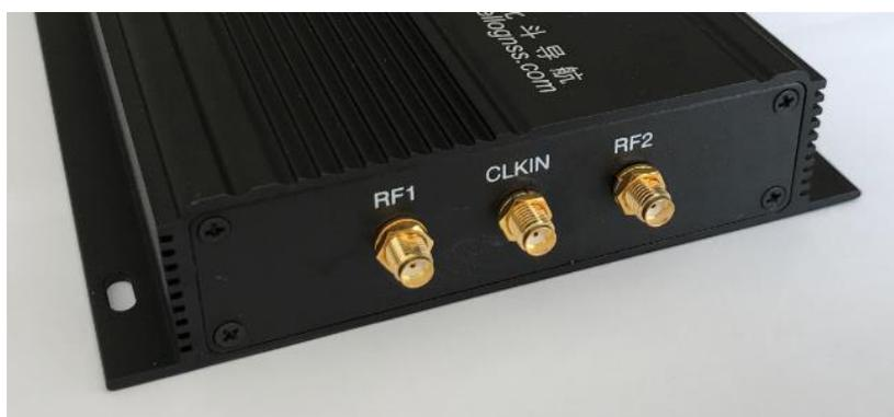
图 3 HG-SOFTGPS06-R 采集器后面板
