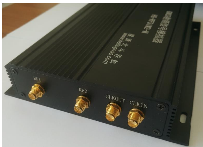
图 6 HG-RFSIM2-M 的后面板
